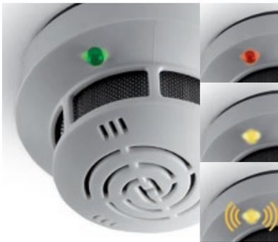
Die **Multi-Betriebszustandsanzeige** zeigt den jeweiligen Zustand wie Betrieb (grün), Alarm (rot), Störung (gelb), Verschmutzung (grün-gelb blinkend), starke Verschmutzung und Austausch (grün-gelb schnellblinkend) an. Anhand der optionalen Rauchschalter-Zustandsanzeige (RZA) lassen sich sämtliche Zustände der angeschlossenen Rauchschalter zentral ablesen und über potenzialfreie Kontakte weiterleiten.
