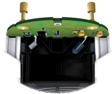
Die anspruchsvolle **Prozessorsteuerung** überwacht kontinuierlich die zuverlässige Betriebsbereitschaft des Rauchschaltes. Durch die zusätzliche Temperatúrauswertung sind Täuschungsalarme aufgrund von Temperaturschwankungen ausgeschlossen. Ebenso sorgen intelligente Softwarealgorithmen dafür, dass der Rauchschalter auch unter schwierigsten Umgebungsbedingungen zuverlässig arbeitet.
