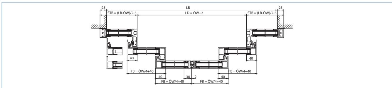
LB = Lichte Bauweite | STB = Seitenteilbreite | LD = Lichter Durchgang | FB = Flügelbreite | ÖW = Öffnungsweite | DH = Durchgangshöhe
