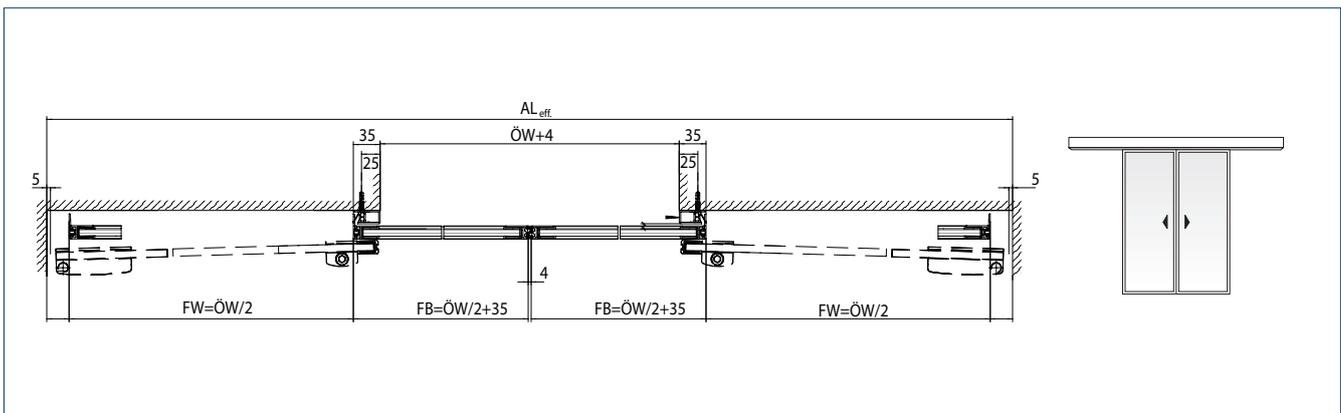
FW = Fahrweg | FB = Flügelbreite | ÖW = Öffnungsweite | Vrs = Antriebsverlängerung rechts | DH = Durchgangshöhe | FH = Flügelhöhe | AL<sub>eff</sub> = Effektive Antriebslänge
