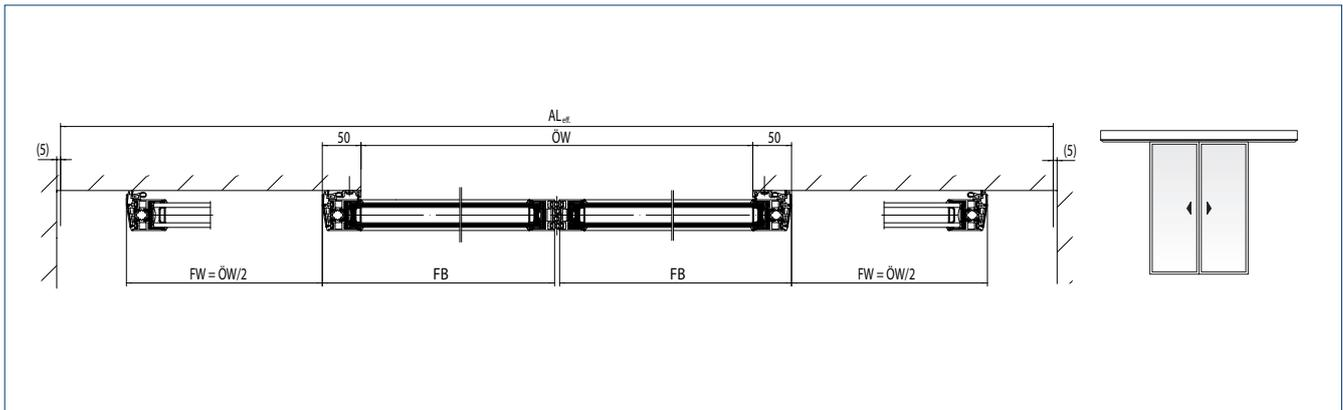
FH = Flügelhöhe | FB = Flügelbreite | FW = Fahrweg | ÖW = Öffnungsweite | DH = Durchgangshöhe | AL<sub>eff.</sub> = Effektive Antriebslänge
