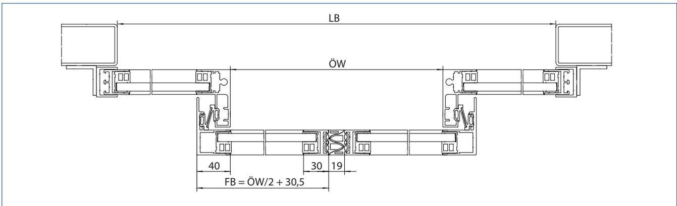
FB = Flügelbreite | LB = Lichte Durchgangsbreite | ÖW = Öffnungsweite | DH = Durchgangshöhe
