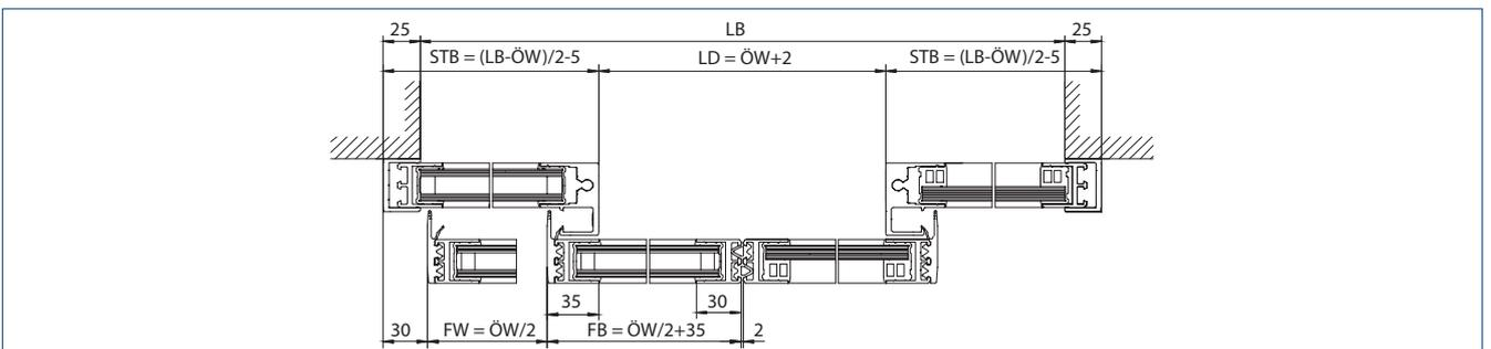
LB = Lichte Bauweite | STB = Seitenteilbreite | LD = Lichter Durchgang | FW = Fahrweg | FB = Flügelbreite | ÖW = Öffnungsweite | DH = Durchgangshöhe
