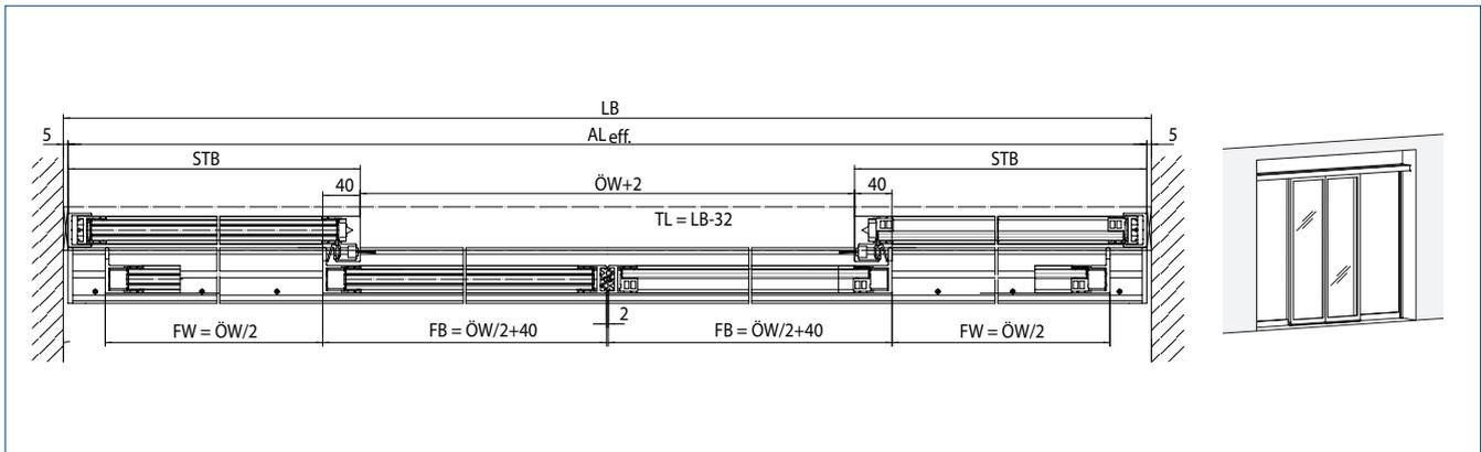
Laibungsmontage, Gummi-Nebenschließkante, Winkel / verstellbare Bodenführung, mit Schutzflügel, ISO und MONO Glas
