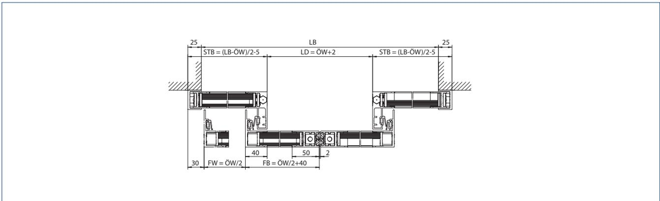
AL = Antriebslänge | FB = Flügelbreite | FW = Fahrweg | DH = Durchgangshöhe | LB = Lichte Bauweite | LD = Lichter Durchgang | ÖW = Öffnungsweite | STB = Seitenteilbreite
