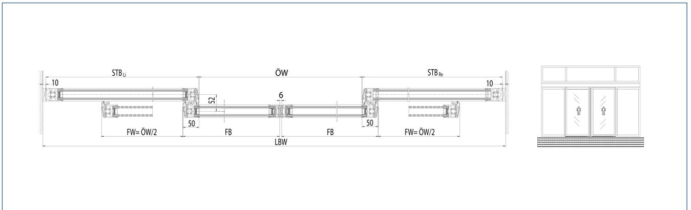
HOL = Höhe Oberlicht | LBW = Lichte Bauweite | LBH = Lichte Bauhöhe | STH = Seitenteilhöhe | STB Li = Seitenteilbreite links |
