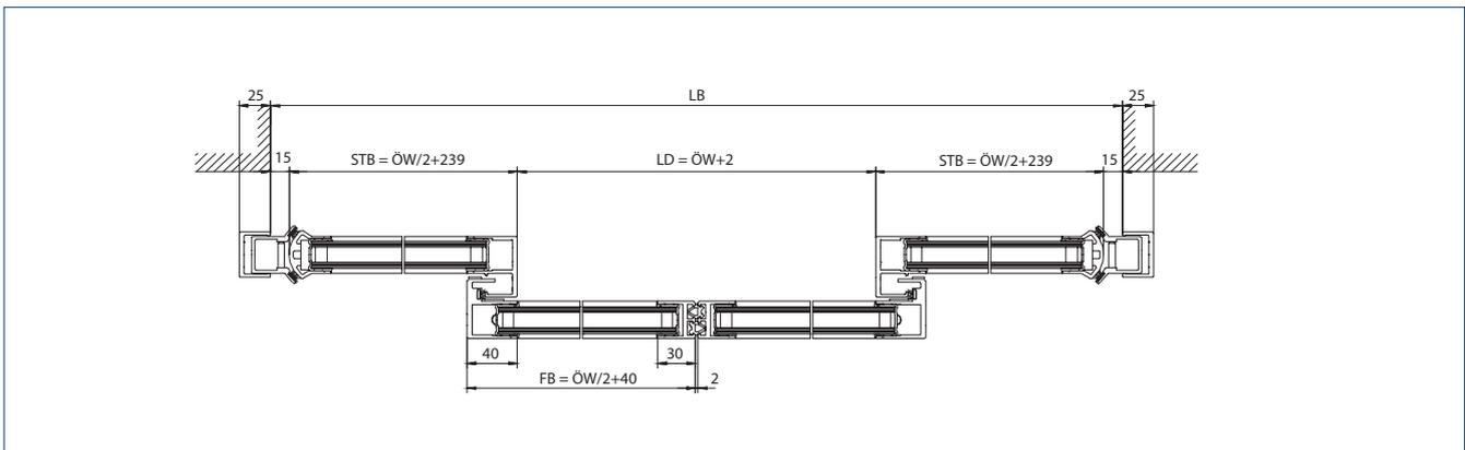
LB = Lichte Bauweite | STB = Seitenteilbreite | LD = Lichter Durchgang | FB = Flügelbreite | ÖW = Öffnungsweite | DH = Durchgangshöhe
