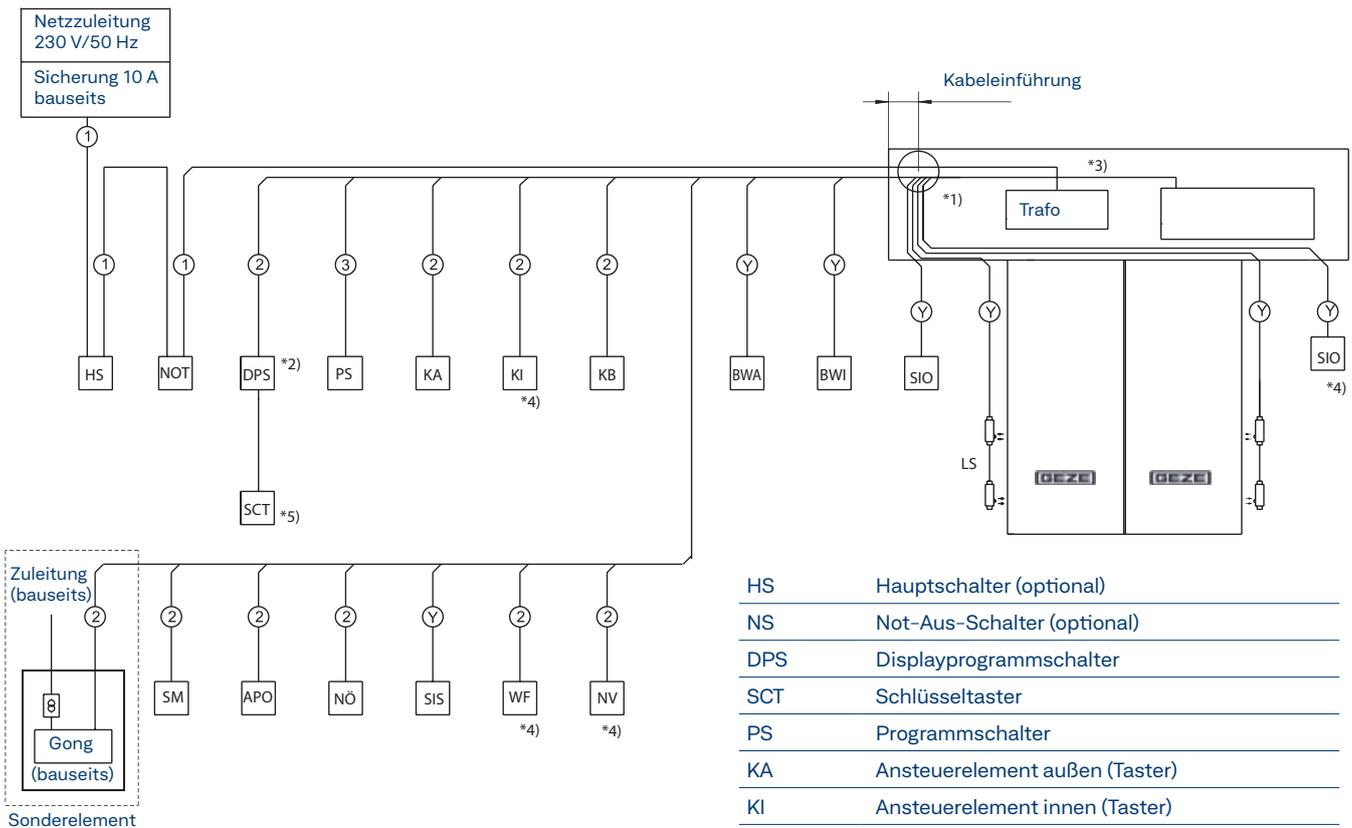
Adernquerschnitt: 1 = NYM-J 3 x 1,5 mm<sup>2</sup> | 2 = I-Y(ST)Y 2 x 2 x 0,6 mm | 3 = I-Y(ST)Y 3 x 2 x 0,6 mm | Y = Lieferumfang GEZE
