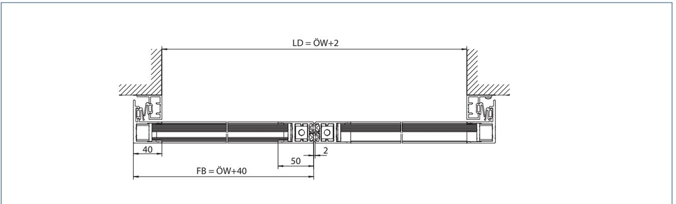
AL = Antriebslänge | LB = Lichte Bauweite | DH = Durchgangshöhe | LD = Lichter Durchgang | FB = Flügelbreite | ÖW = Öffnungsweite
