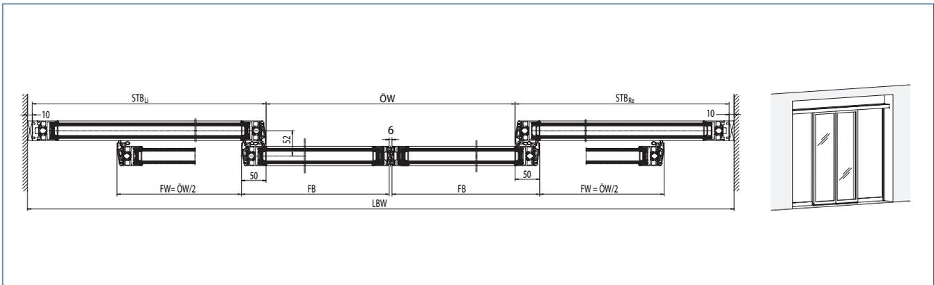
LBW = Lichte Bauweite | LBH = Lichte Bauhöhe | STH = Seitenteilhöhe | STB Li = Seitenteilbreite links | STB Re= Seitenteilbreite rechts | FW = Fahrweg | FB = Flügelbreite | FH = Flügelhöhe | ÖW = Öffnungsweite | DH = Durchgangshöhe
