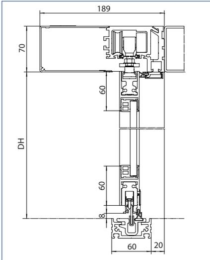
Antrieb mit Seitenteilen an Riegelprofil
