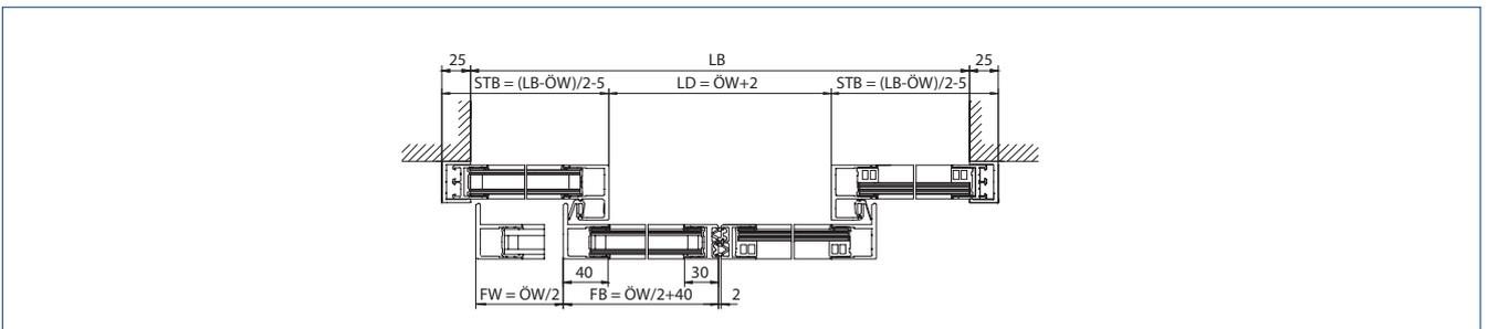
LB = Lichte Bauweite | LD = Lichter Durchgang | FW = Fahrweg | FB = Flügelbreite | STB = Seitenteilbreite | DH = Durchgangshöhe | ÖW = Öffnungsweite
