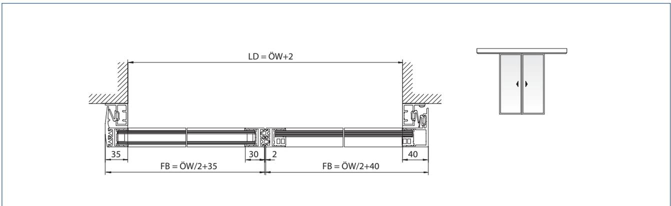
LD = Lichter Durchgang | FW = Fahrweg | FB = Flügelbreite | ÖW = Öffnungsweite | VRS = Antriebsverlängerung rechts | DH = Durchgangshöhe
