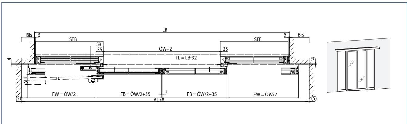
LB = Lichte Bauteile | STB = Seitenteilbreite | STH = Seitenteilhöhe | FH = Flügelhöhe | FB = Flügelbreite | FW = Fahrweg | ÖW = Öffnungsweite | DH = Durchgangshöhe | TL = Trägerlänge | Bls = Befestigung links | Brs = Befestigung rechts | AL eff. = Effektive Antriebslänge
