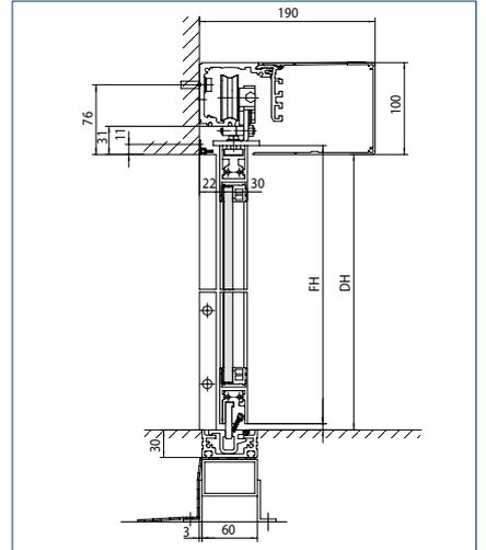
1-flügelig, Wandmontage, ALU-Nebenschließkante, Winkelbodenführung, rechts schließend, MONO-Glas
