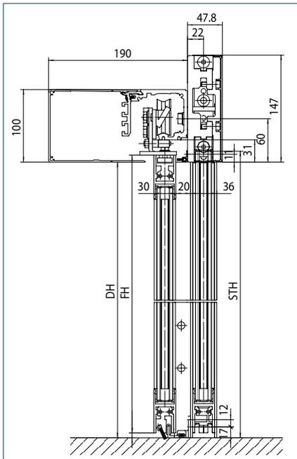
Laibungsmontage, Alu-Nebenschließkante, durchgehende Bodenführung, ISO und MONO Glas
